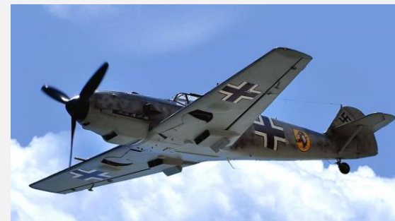
Chasseur BF 109_ 570 km/h _ 1475 ch 1 canon de 20mm _ 2 MG 131 de 13mm
