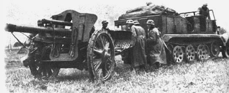
Tracteur d'artillerie Sd.Kfz. 6-1 avec le I.F.H.18 de 10,5 cm
