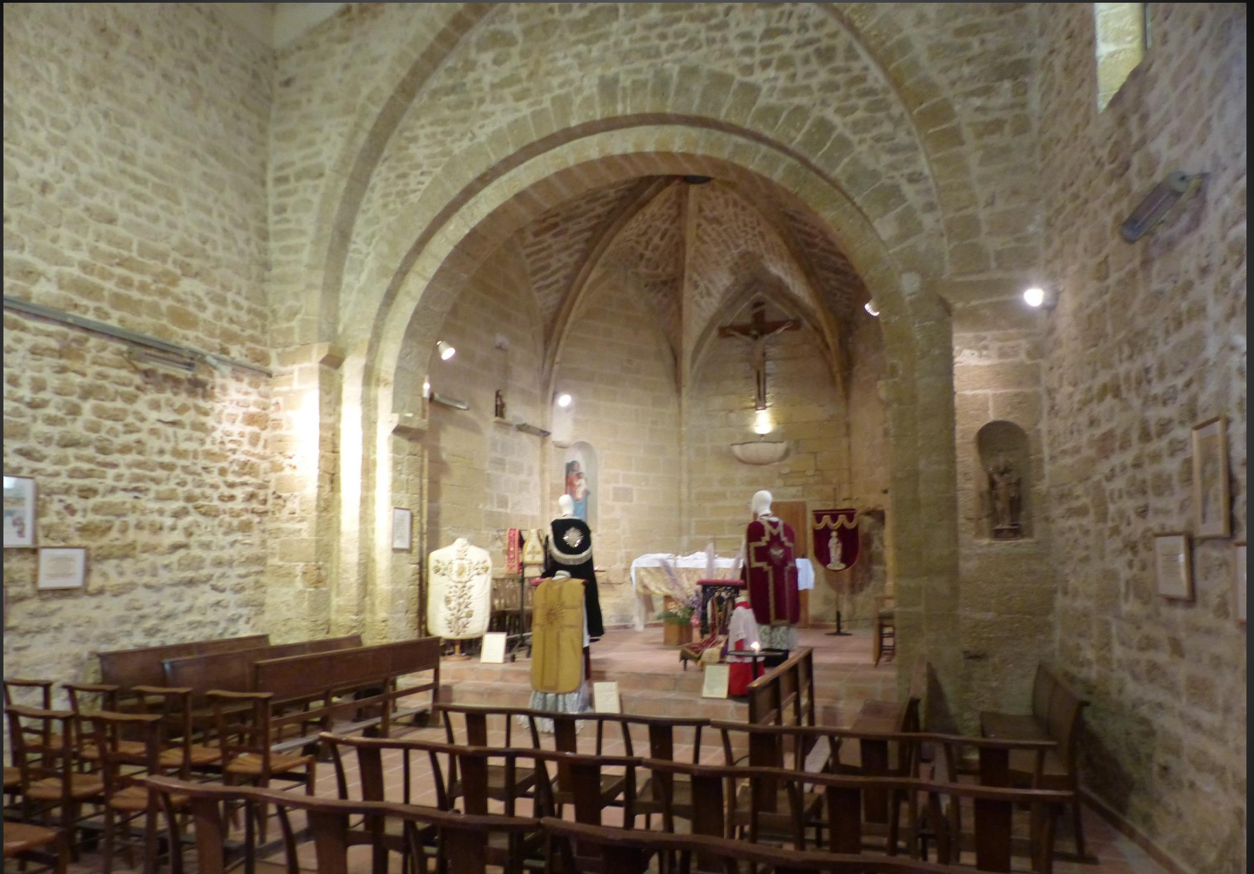
Notre-Dame-de-Beauvezet : une porte en tiers-point à arête et à l'archivolte décorée d'un boudin permet de pénétrer à l'intérieur de l'église, laquelle, restaurée en 1978, se compose d'une nef à travée légèrement déviée, couverte en charpente et tuiles et d'une abside à cinq pans survoûtés d'ogives. Dans une tourelle débouchant dans la sacristie, un escalier en vis permet d'accéder au clocher avec arcades à trois baies posées sur l'arc triomphal.
