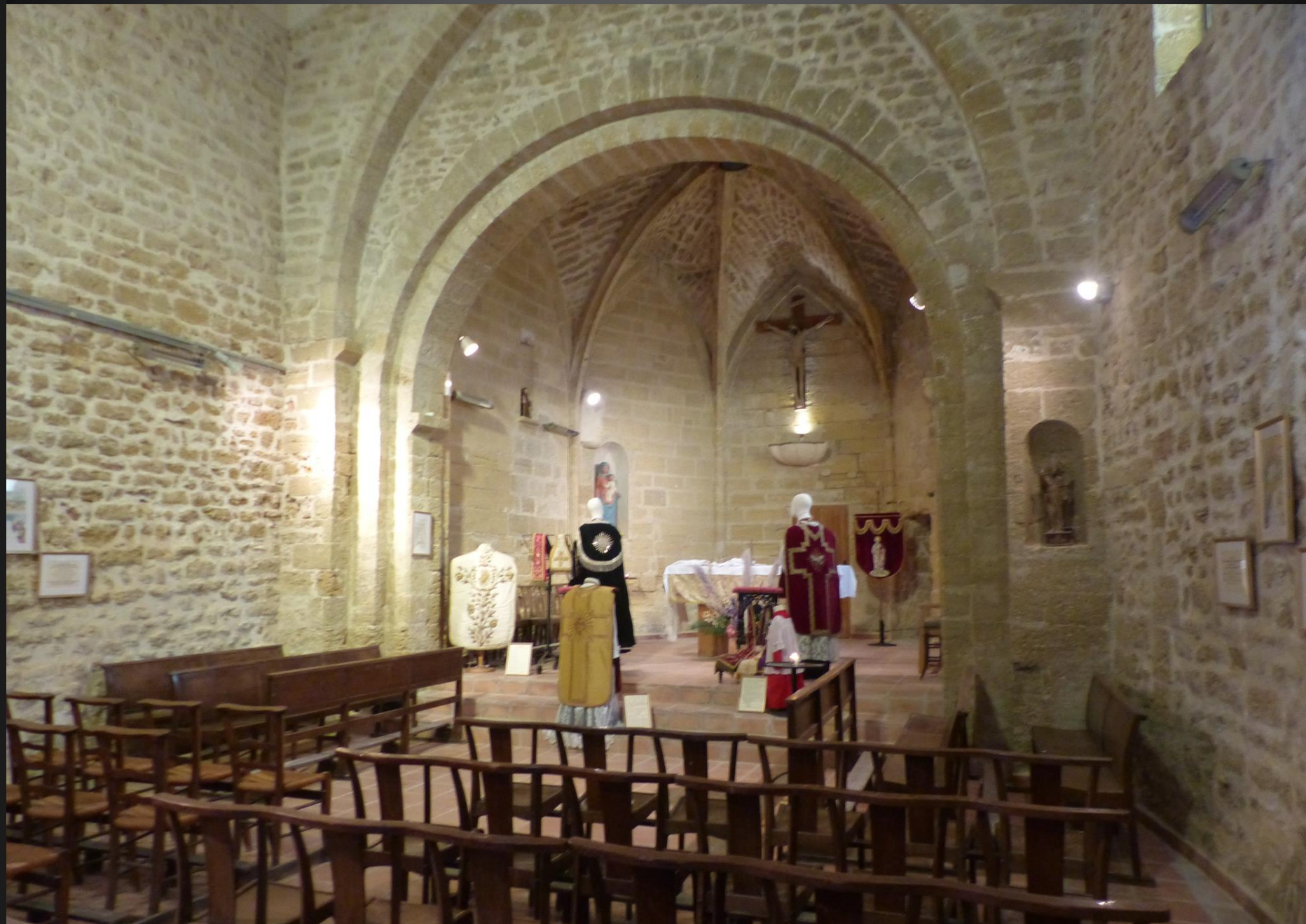
Notre-Dame-de-Beauzezer _ L'édifice, restauré en 1978, se compose d'une nef à travée légèrement déviée, couverte en charpente et tuiles et d'une abside à cinq pans survoûtés d'ogives avec arcades à trois baies posées sur l'arc triomphal. Dans une tourelle débouchant dans la sacristie, un escalier en vis permet d'accéder au clocher.
