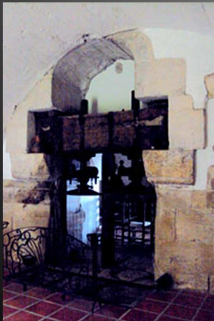
La presse à scourtins; l'aire de broyage avec les meules de pierre, le cône en haut recevait les olives par une trappe; les deux verins sont encore en place...
