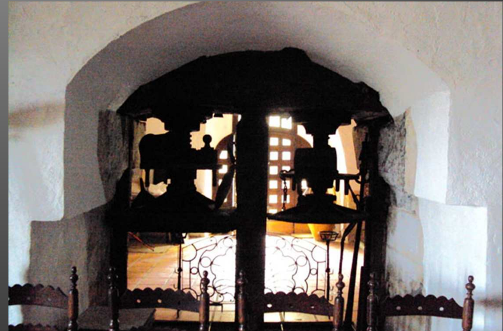
La presse à scourtins; l'aire de broyage avec les meules de pierre, le cône en haut recevait les olives par une trappe; les deux verins sont encore en place...
