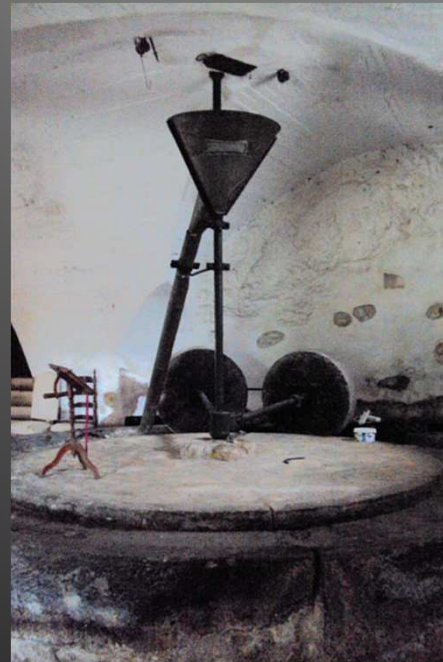
La presse à scourtins; l'aire de broyage avec les meules de pierre, le cône en haut recevait les olives par une trappe; les deux verins sont encore en place...
